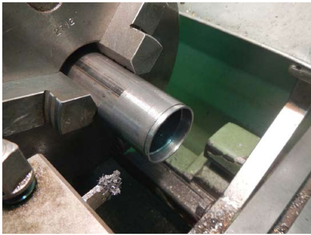
Ein Rohling mit Nute wird gedreht
