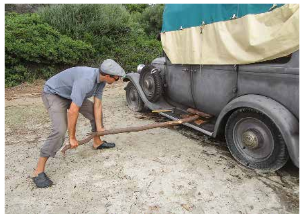
Richtarbeiten: Aufsetzer hatten die Trittbretter eingedrückt, und nun klemmten die darauf montierten Kisten (Foto oben)
