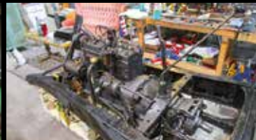
Zwischenetappe: Motor und Getriebe sitzen schon wieder im Rahmen
