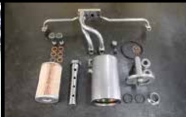
...und mit einem komplett neuen, selbst konstruierten Ölkreislauf ausgestattet...
