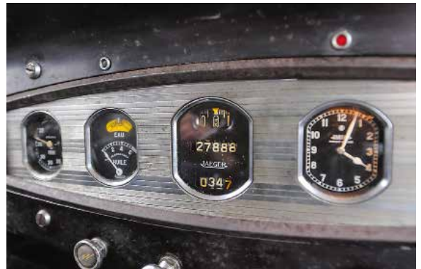
Stilvolles Instrumentarium in besserer Briefmarkengröße: Der Tacho zeigt oben das Tempo mittels laufendem Zahlenband
