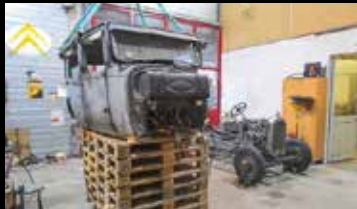
Mit Stapler und Flaschenzug: Hülle und Chassis kurz vor der Verbindung
