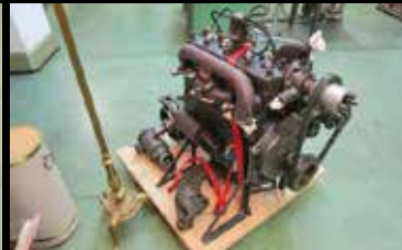
Der seitengesteuerte Vierzylinder nach der kompletten Revision aller Bauteile
