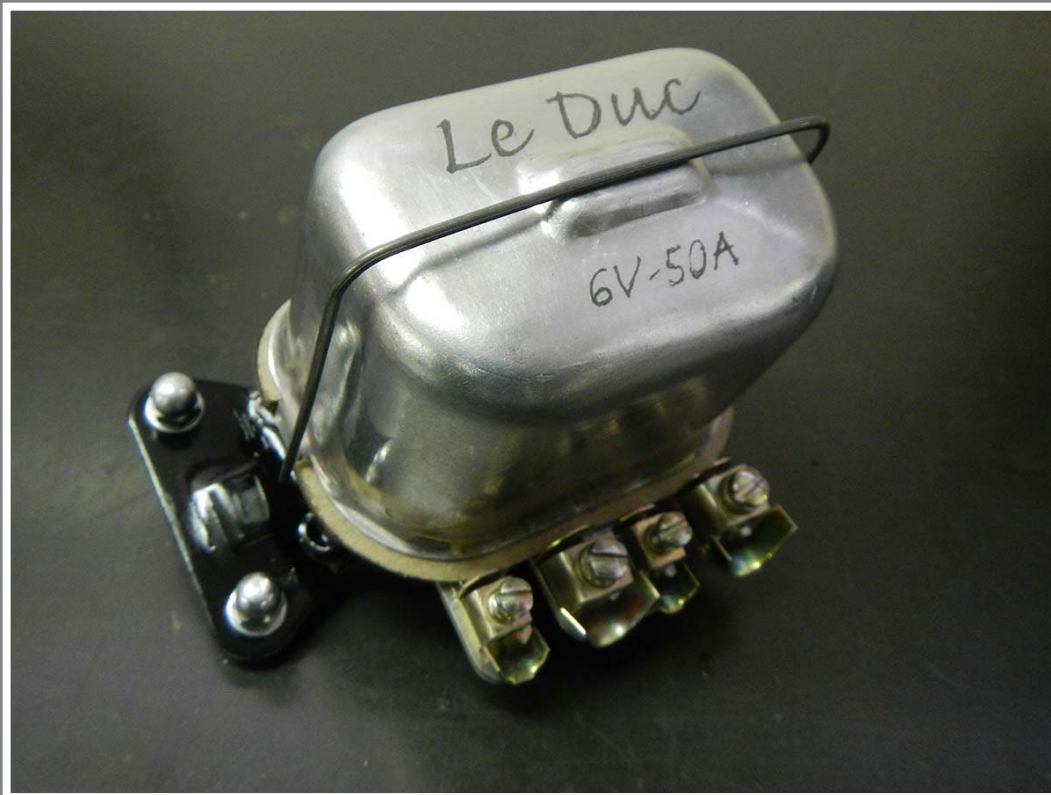
Regler mit versteckter Adapterplatte (ohne Anpassungen montierbar)
